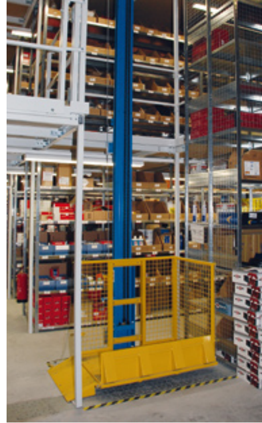
Lift zur Materialbeschickung der Fachbodenregalebenen
